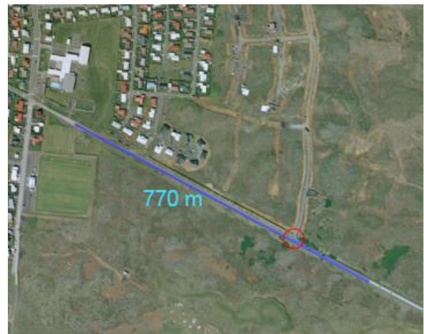
Mynd 3.12 Sandgerðisvegur. Bláa línan sýnir fjarlægð frá þéttbýlisskilti að fyrstu gönguþveruninni við bæinn, alls 770 m. Rauður hringur táknar gatnamót við Byggðaveg.
